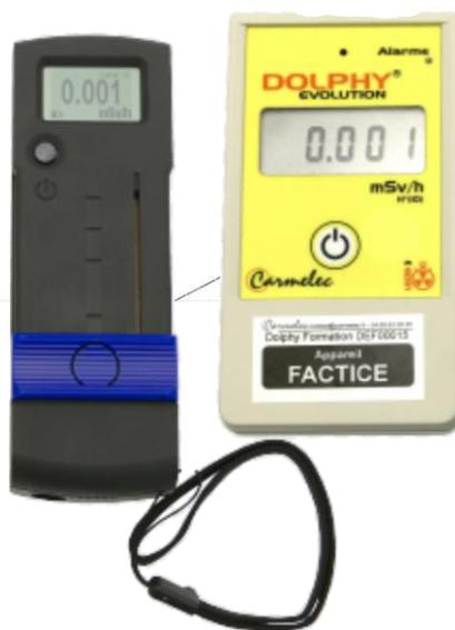
Le Dolphy Formation et sa télécommande sont un ensemble radio-communicant permettant de simuler des situations d'irradiation dans le but de former les intervenants en milieux ionisants.
